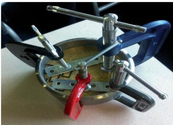
**Figura 6.** Compresión de la fibra de caña de azúcar para obtención de muestras.
