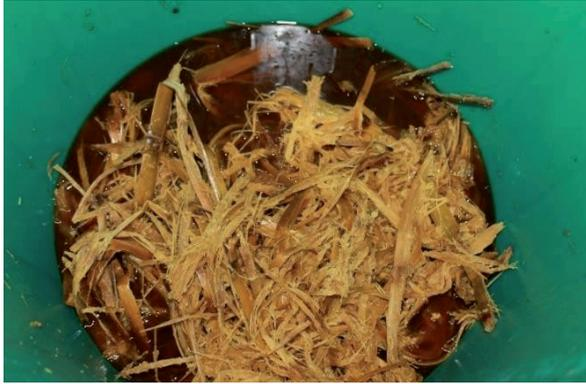
**Figura 3.** Bagazo de caña de azúcar sumergido en hidróxido de sodio
