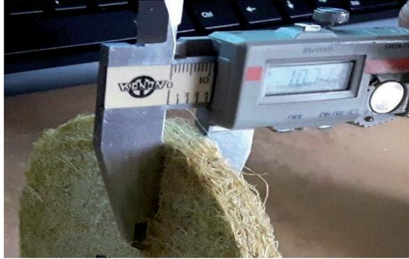
**Figura 8.** Espesor de la muestra de fibra de caña de azúcar No. 7.
