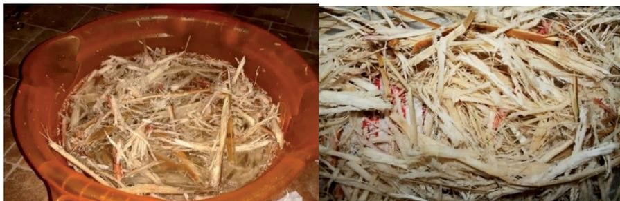
**Figura 2a.** Desmedulado en suspensión del bagazo de caña de azúcar. **2b.** Secado al sol del bagazo de caña resultante
