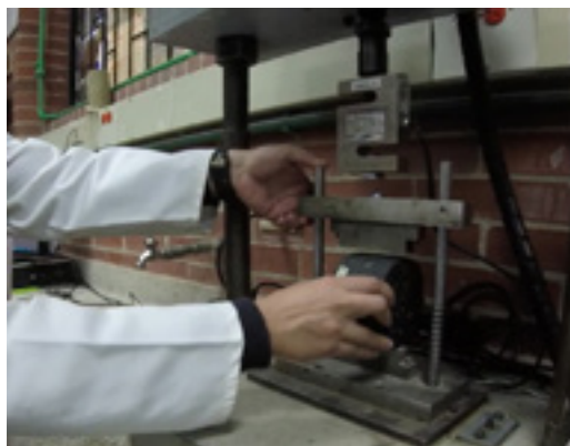
Figura 1. Montaje de una probeta de mezcla asfáltica
