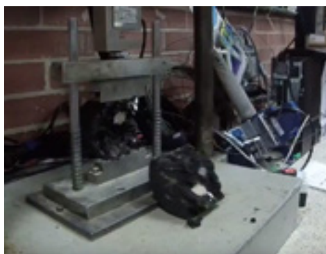
Figura 2. Ruptura de una probeta de muestra asfáltica
