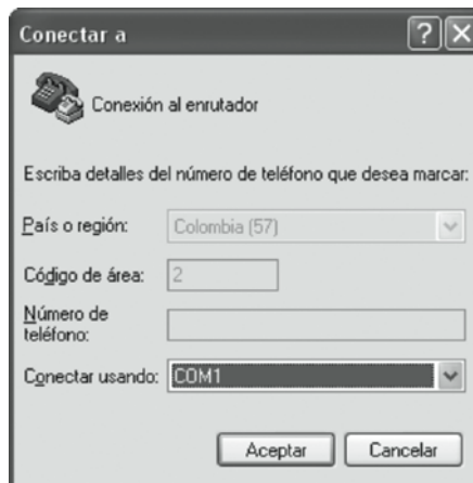
Figura 4 Conexión de consola al enrutador -Conectar a-
